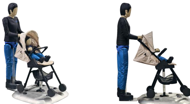
图 6 推婴儿车行人目标物外观示意图
