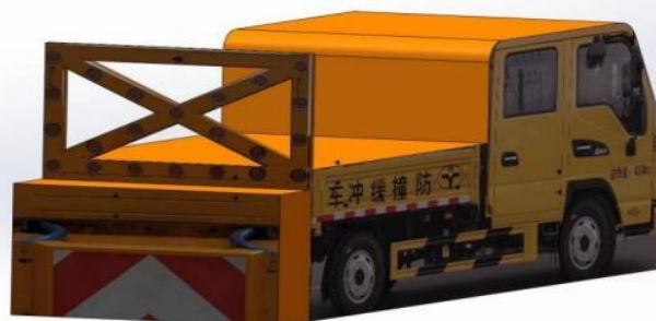
图D.3 防撞缓冲车目标物外观
