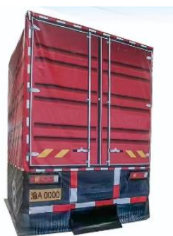
图P.5 卡车柔性目标物外观
