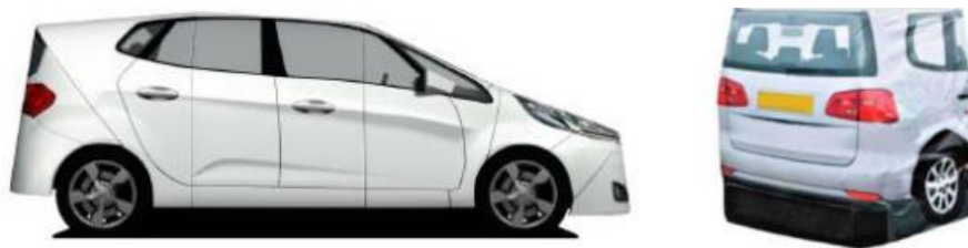
图 F.5 试验目标物-乘用车柔性目标物外观示意图
