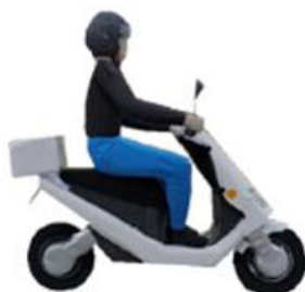
图P. 12 踏板车骑行者目标 STA 外观
