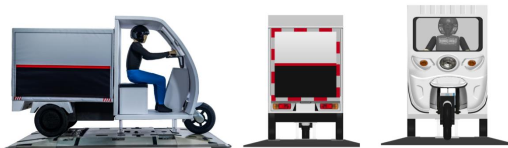
图 B. 7 快递三轮车柔性目标物外观
