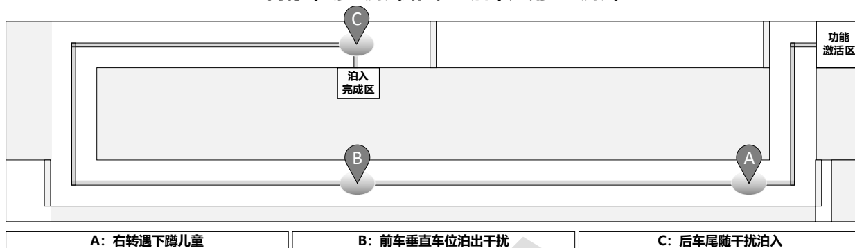
图JA.9 室内停车场测试路线一泊车应用B组测试场景设置示意图
