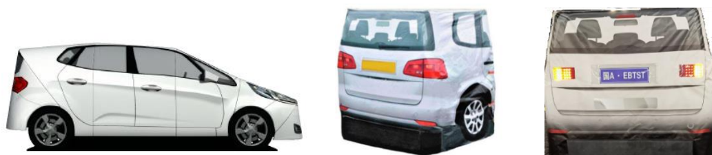
图 B.6 乘用车柔性目标物外观（3D 整车目标物、不带灯光系统、带灯光系统）
