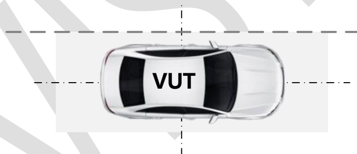
图H.6 泊车能力试验试验车辆泊出开始状态
