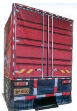
图 F.6 卡车柔性目标物外观示意图
