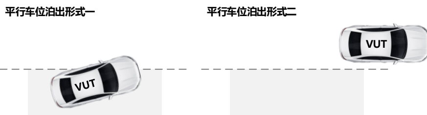
图IB.2 平行车位两种泊出的形式
