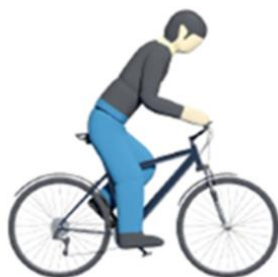
图 F. 13 自行车骑行者目标物 ABT 外观示意图
