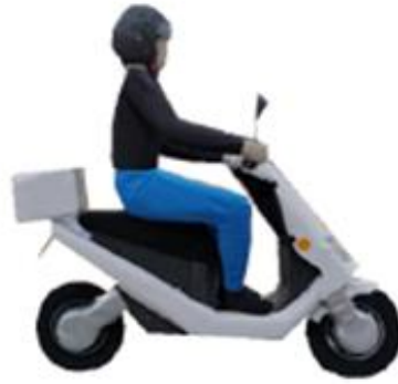
图 F.14 踏板车骑行者目标物 STA 外观示意图
